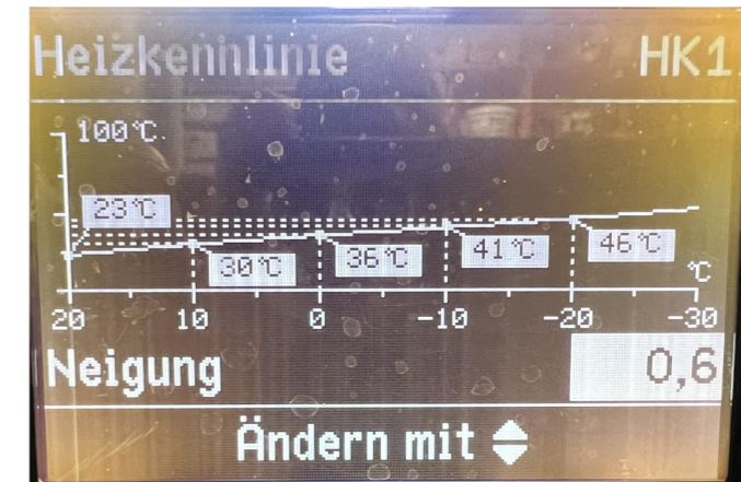
Viessmann Vitodens 300 liefert Wärme bei Temperaturen unter -0,5 °C in den 820 Liter Pufferspeicher + 1 x täglich um 18:00 Uhr Brauchwassererwärmung.
